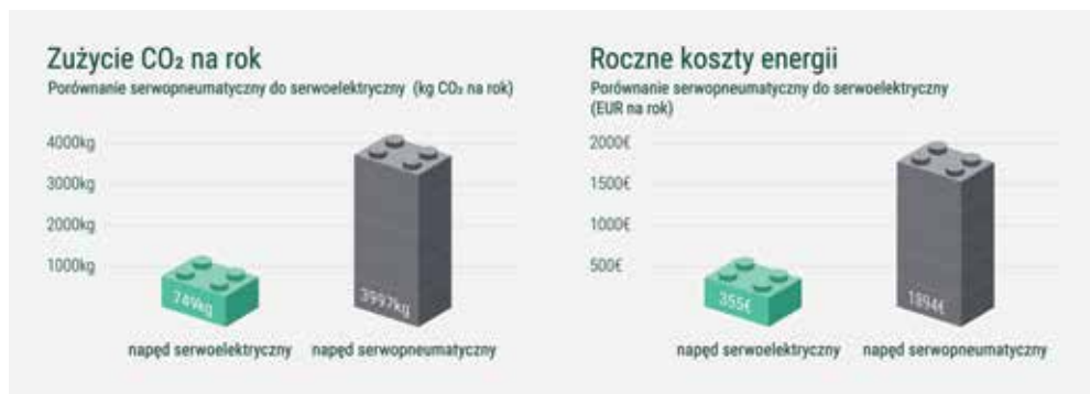
Rys. 1 | Napęd serwoelektryczny pozwala zaoszczędzić 4/5 spośród całkowitych kosztów energii generowanych przez napęd serwo-pneumatyczny, w dodatku umożliwia zmniejszenie emisji CO 2 o 80%.
