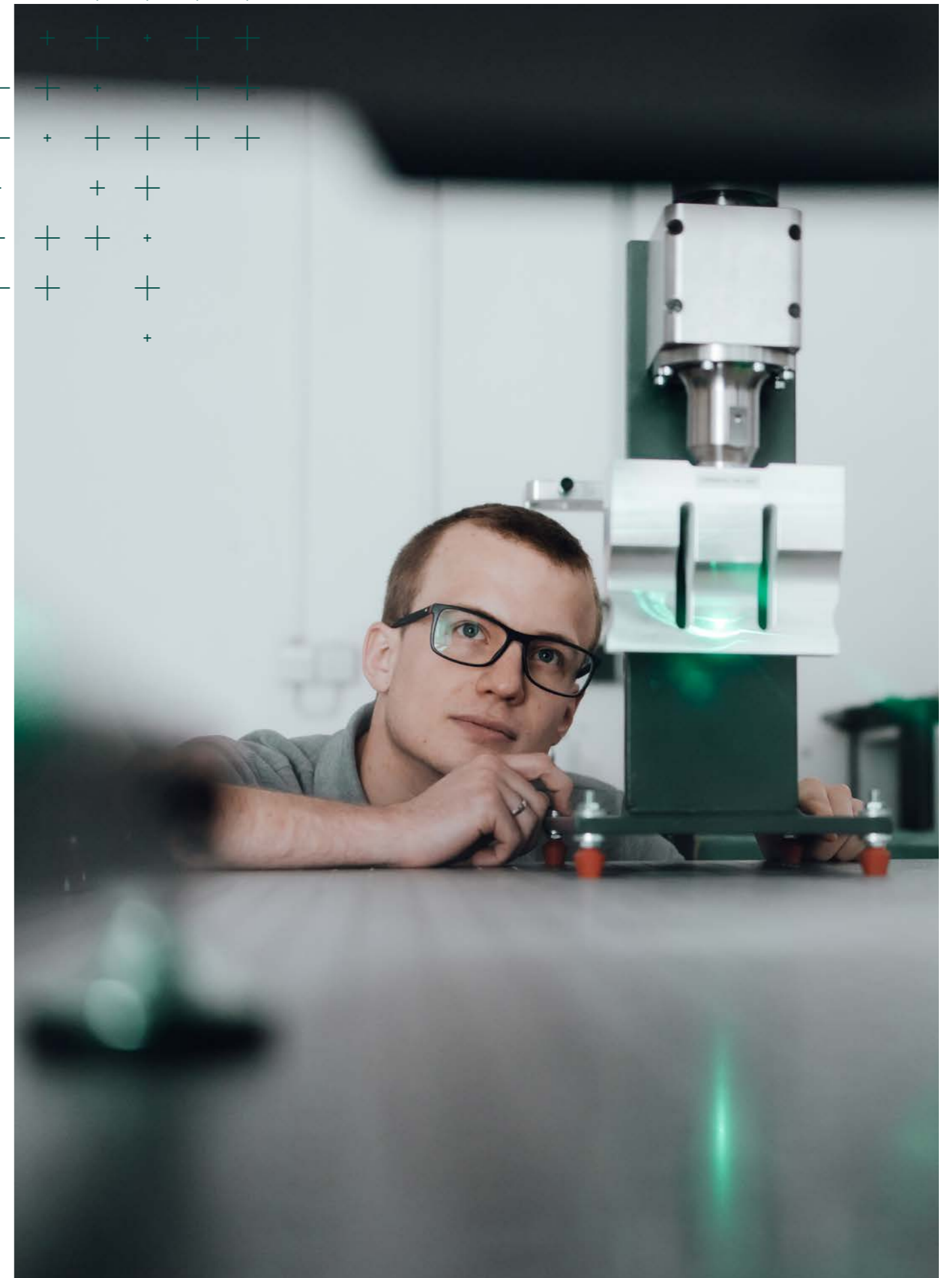
Mit dem Laservibrometer erhält man genaue Informationen über die Geschwindigkeit und Amplitude von Schwingungen.
